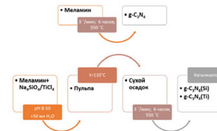
Рис. 2. Технология получения графитоподобных катализаторов на основе меламина
