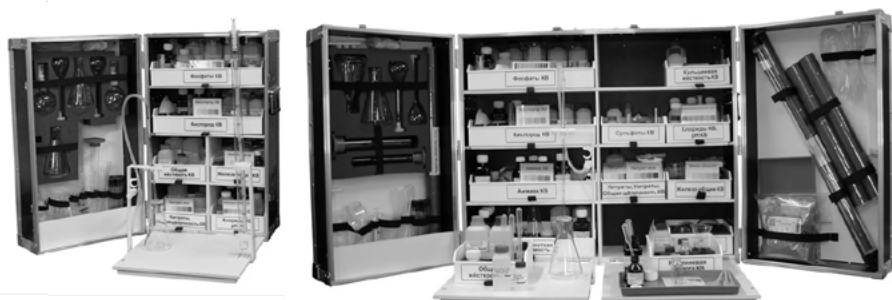
Рис.1 Водно-химические экспресс-лаборатории ВХЭЛ-1 и ВХЭЛ-3
