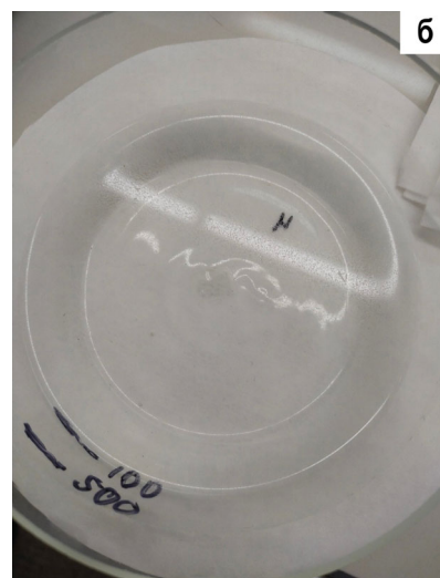
Рис. 1. Процесс выпаривания на песчаной бане (а), образование осадка на поверхности раствора после упаривания (б)
