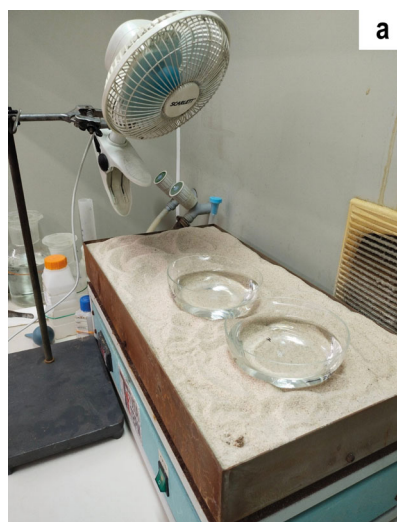
Рис. 1. Процесс выпаривания на песчаной бане (а), образование осадка на поверхности раствора после упаривания (б)
