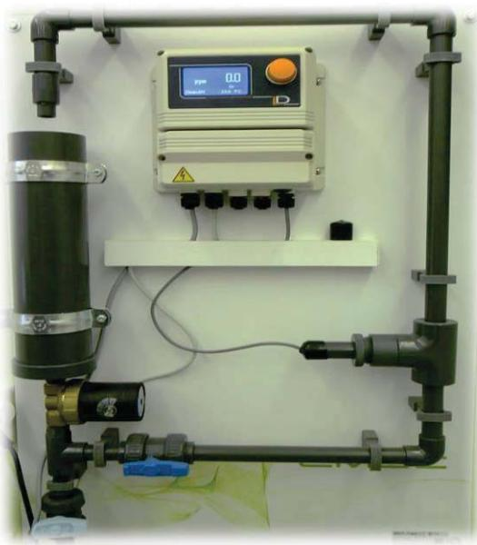
Рисунок 4 – Стенд для испытаний флуоресцентных ингибиторов солеотложения – EMEC (Liquid Control Systems) – Италия, установленный в ПАО НЦ «Малотоннажная химия»
